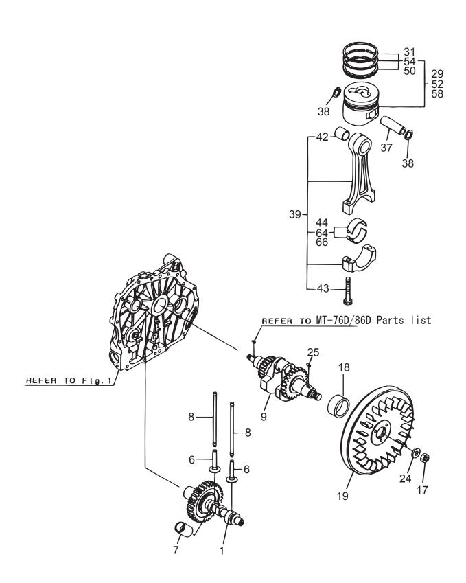
L48N6-SMK (FOR MT-76D/86D) 4. CRANKSHAFT,PISTON & CAMSHAFT/クランクシャフト&ピストン
